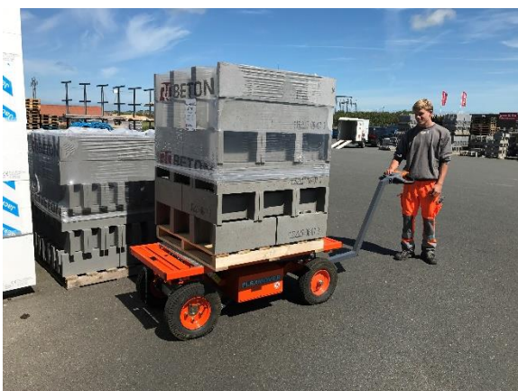
Elektrisk drevet vogn til transport af gipsplader og bygge materialer
